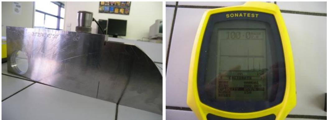
En utilisant la cale calibrée, on mesure une distance de 100 mm et on déduit donc que la vitesse des US dans l'acier est de 5976  $\text{m} \cdot \text{s}^{-1}$ . L'appareil est ainsi étalonné pour mesurer d'autres dimensions et éventuellement pour déterminer la position de défauts dans ce même matériau.
