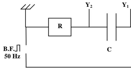
Le générateur B.F. sera utilisé avec son amplificateur afin d'éviter les déformations du signal. Faire attention de bien régler la hauteur du signal et l'amplification sur des valeurs moyennes :
