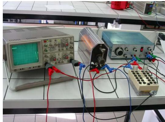
Le générateur B.F. sera utilisé comme précédemment avec son amplificateur afin d'éviter les déformations du signal. Faire toujours attention de bien régler la hauteur du signal et l'amplification sur des valeurs moyennes.
