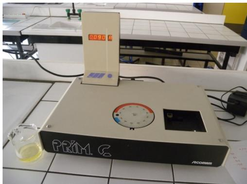
On remplit un godet d'une solution de sulfate de cuivre  $0,05 \text{ mol.L}^{-1}$ . Le godet est placé dans le compartiment.
