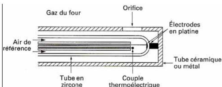
3. La différence de potentiel  $e$  aux bornes d'une sonde à oxygène est fonction de la température  $T$ , de la pression partielle en dioxygène dans le four  $P_{O_2 \text{ Four}}$  et de la pression de dioxygène dans l'air  $p_{O_2 \text{ Réf}} = 0,209$  bar. Elle est donnée par la relation :
